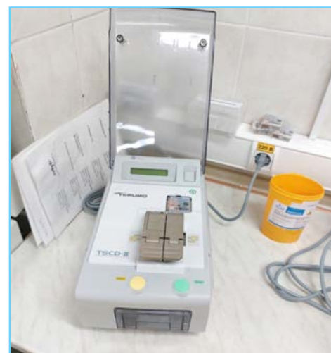
Устройство для стерильного запаивания трубок пластиковых контейнеров с кровью TSCD-II
