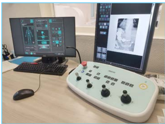
Программное обеспечение АПФ позволяет автоматически выбирать органы и системы, просто нажимая на образ человека на экране.
