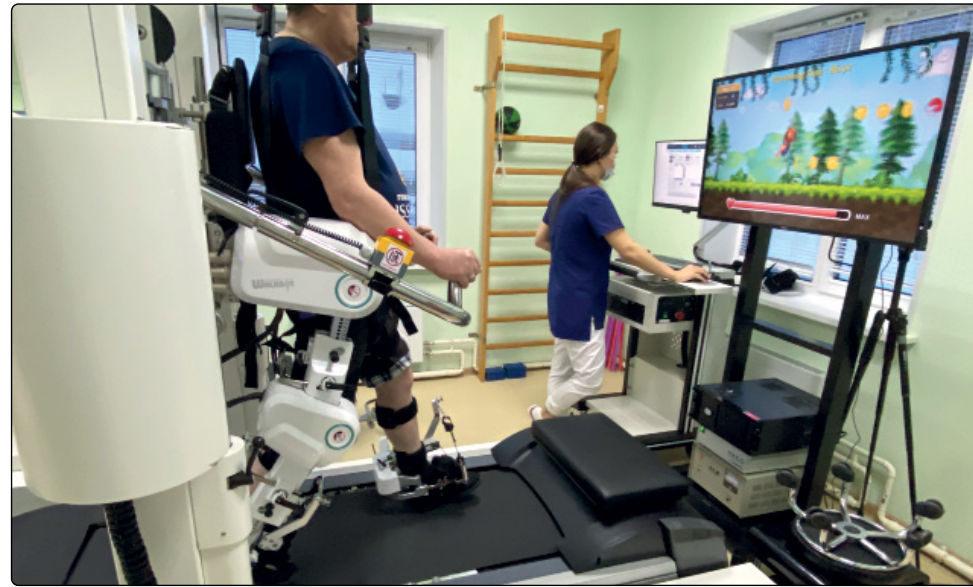
Walkbot S – специализированная роботизированная система, обеспечивающая профессиональную локомоторную восстановительную терапию у взрослых пациентов для восстановления функции ходьбы
